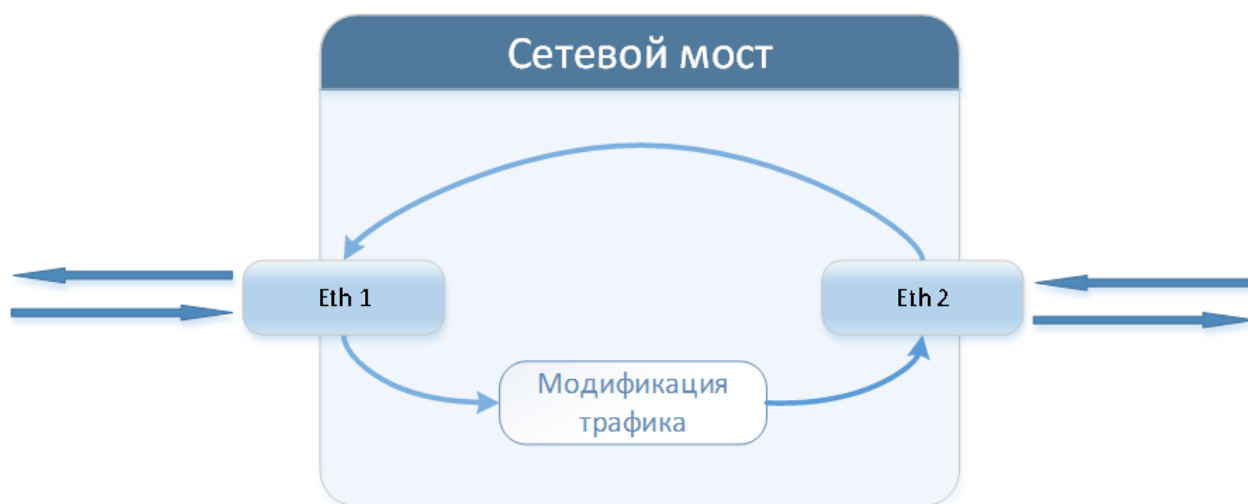
Рис. 8. Работа сетевого моста с модификацией трафика
