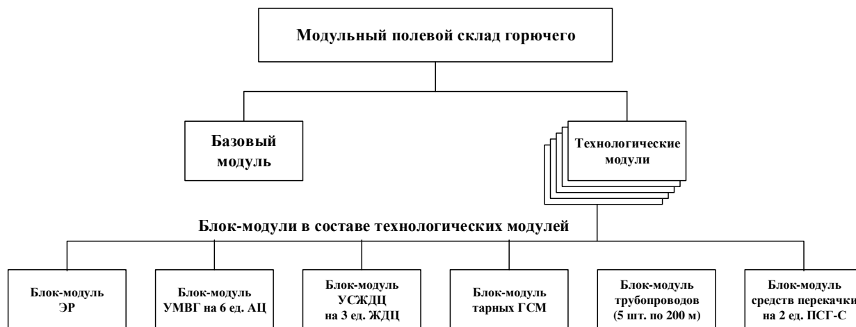
Рис. 2. Принципиальная схема состава и структуры МПСГ (вариант)
